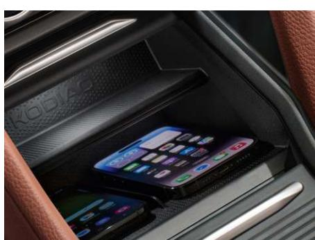
Bezvadu uzlādes funkcija diviem tālruņiem ar jaudu 15 W katram un dzesēšanas funkciju (bezvadu uzlāde).
